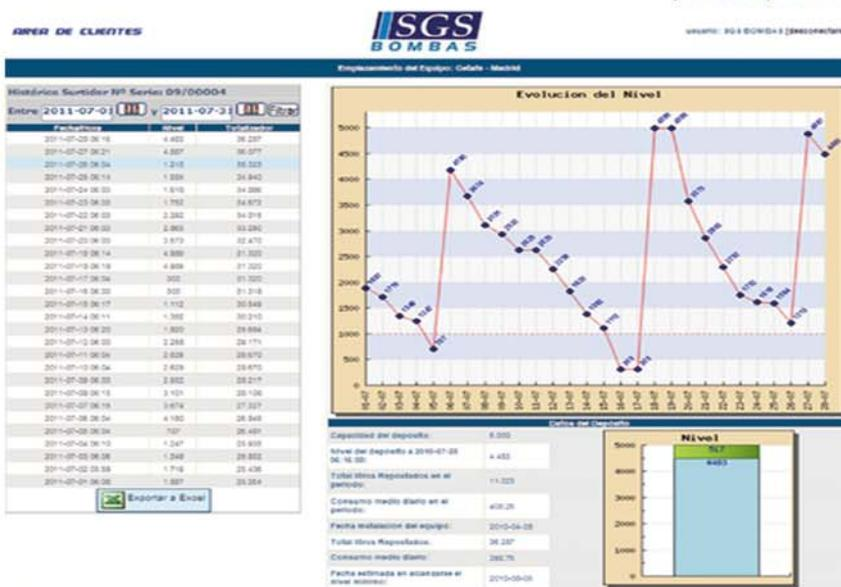
El módulo permite visualizar in-situ el nivel del depósito y previa contratación anual del sistema MTL (Metering Tank Level) podremos descargar la información desde cualquier punto con conexión a INTERNET, a través de nuestra pag. web [www.sgsbombas.com](http://www.sgsbombas.com), La descarga de información será de una vez al día.
